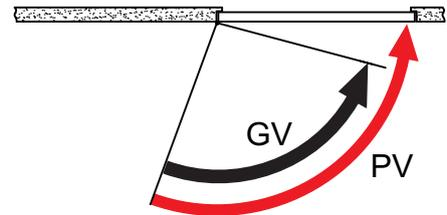
La superposition des deux zones de réglage PV et GV offre l'assurance d'une vitesse de fermeture finale sécurisée.
