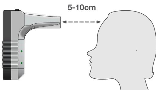
**Mesure la température corporelle** à une distance de 5 à 10cm. Le résultat est affiché sur l'écran et l'alarme sonne en cas de détection de température trop élevée.
