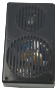
A663A Ampli (micro+HP) Installé en toit de cabine
